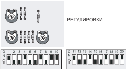
УСТАНОВКА МИКРОПЕРЕКЛЮЧАТЕЛЕЙ БЛОК УПРАВЛЕНИЯ "MASTER"
