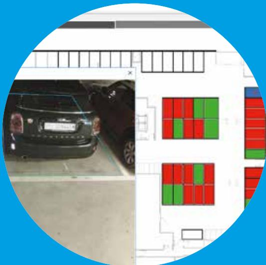
Система парковочной навигации показывает пользователям доступные места и кратчайший маршрут, чтобы добраться до них. За счет этого достигается повышение эффективной емкости парковки и сокращение эксплуатационных затрат. Кроме того, система позволяет операторам контролировать заполняемость автостоянки и следить за её состоянием в режиме реального времени.
